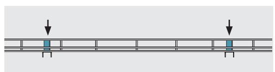
Une plus grande distance entre les fixations implique moins de travail et des coûts inférieurs. Nous recommandons une distance entre supports de 2,25 mètres ou, avec X-Guard, adaptée aux distances entre poteaux.
