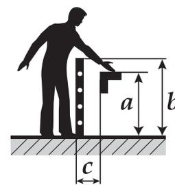
**a** Les structures de protection d'une hauteur inférieure à 1000 mm ne sont pas incluses car elles ne limitent pas suffisamment les mouvements du corps.
