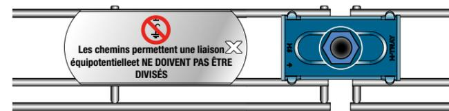
Dans certaines installations, le chemin de câbles doit avoir une liaison équipotentielle. Elle doit assurer une liaison de protection de sécurité ou une liaison fonctionnelle.
